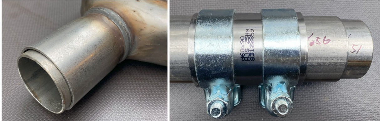
Venstre: styrebøsning indløb. Højre: 60mm samler og reduktioner til udløb.
